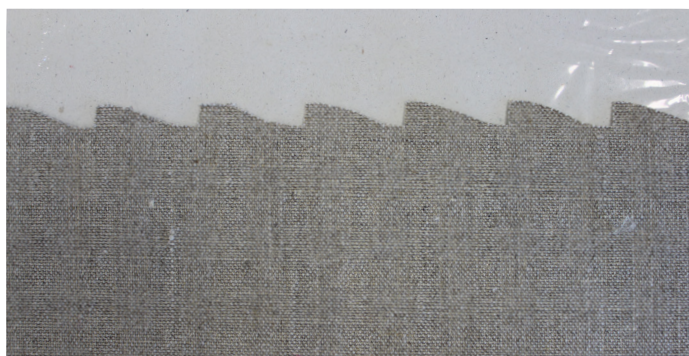
Fig. 43. Detalle del patrón del mordido. Reverso del tejido de lino imprimado
