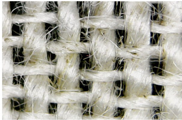
Fig. 31. Detalle entramado tela de lino. Microscopio USB Jiusion, x80.
