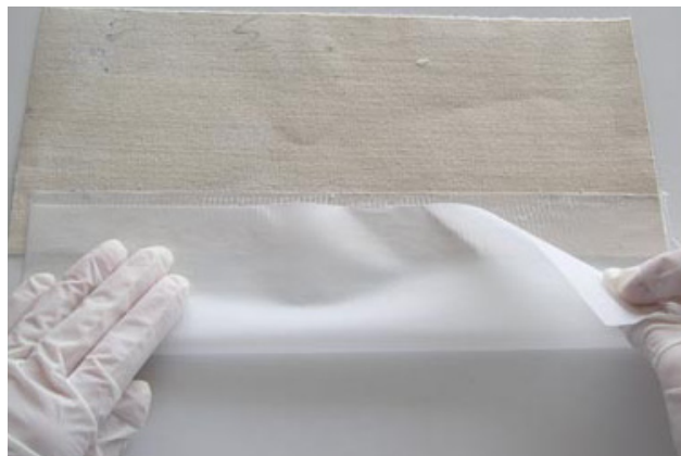
Fig. 12. Preparación de borde de refuerzo mediante tejido no tejido, generando la banda doble
