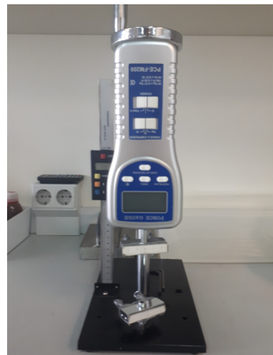
Fig. 47. Dinamómetro empleado para los ensayos
