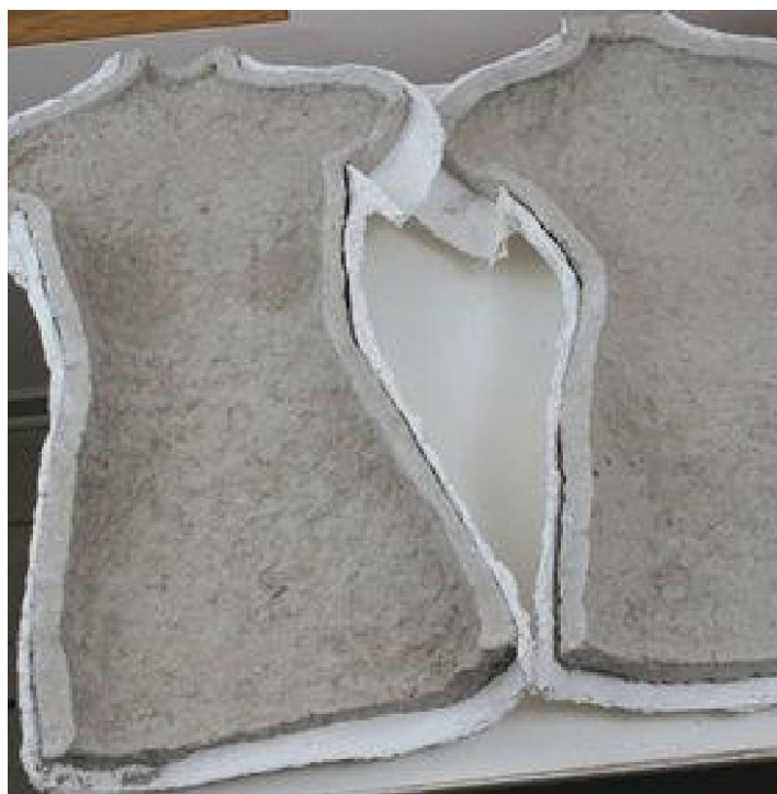
Fig. 113. Moldes de escayola con la pasta de papel ya compactada. En la imagen puede corroborarse el grosor que pueden alcanzar las piezas.
