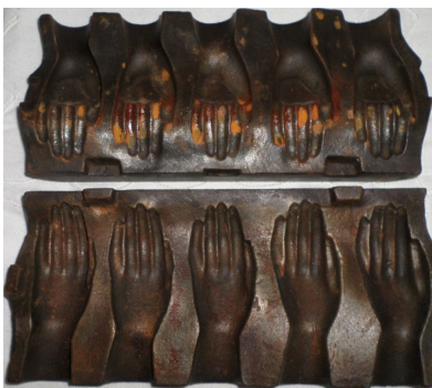
Fig. 107. Molde de bronce de cerrojo para la factura de manos para muñecos.
