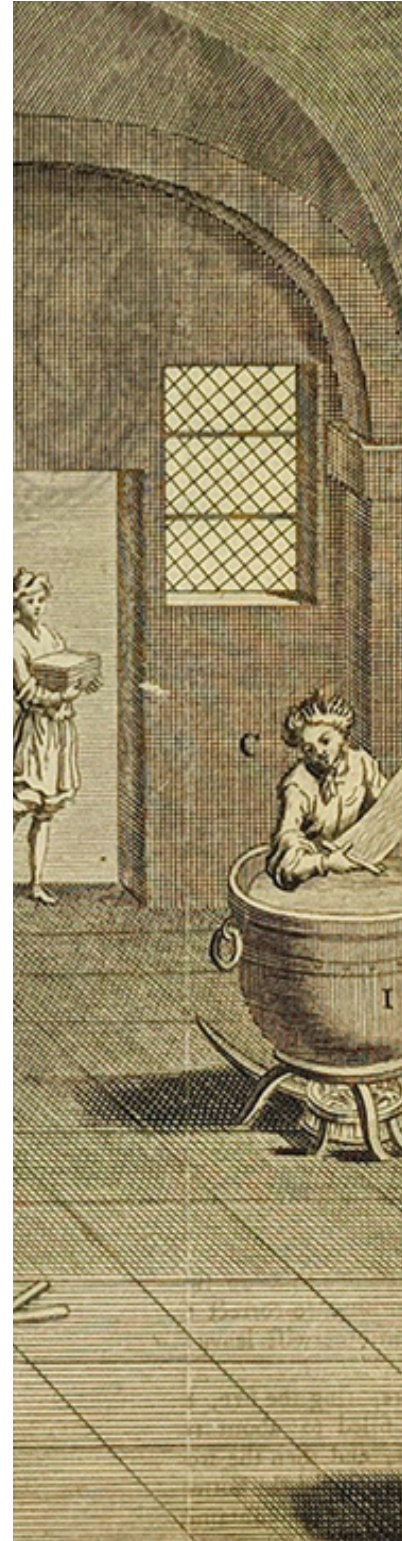
Fig. 1. Grabado que muestra a un laurente o formador, trabajador encargado de dar forma al papel introduciendo un tamiz en una tina y extrayendo la cantidad de pulpa de papel necesaria. Imagen extraída de Art de faire le papier de Joseph Jerome de la Lande, obra publicada en 1761. Academia de Ciencias de París.
