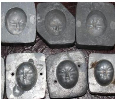
Fig. 108. Molde de plomo de cerrojo para la factura de cabezas para muñecos.
