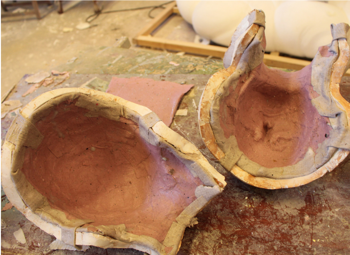
Fig. 110. El cartón “atado” a los bordes del molde durante el proceso de secado para evitar posibles deformaciones. Fotografía: Julián Otero.
