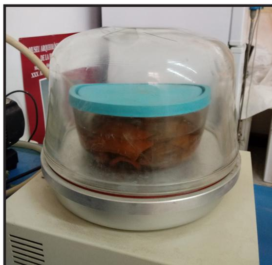
Imagen 74. Máquina de vacío.
