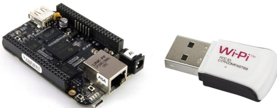
*Figura 9 Placa BeagleBone Black y Adaptador Inalámbrico Wi-Pi.*
