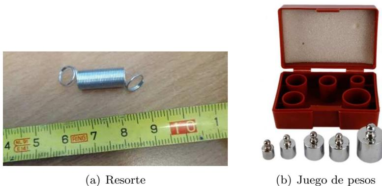
Figura 3.11: Muelle y juego de pesos de calibración para medir la rigidez.
