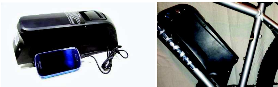
Figura 5.23. Baterías GP situadas en el porta botellas
