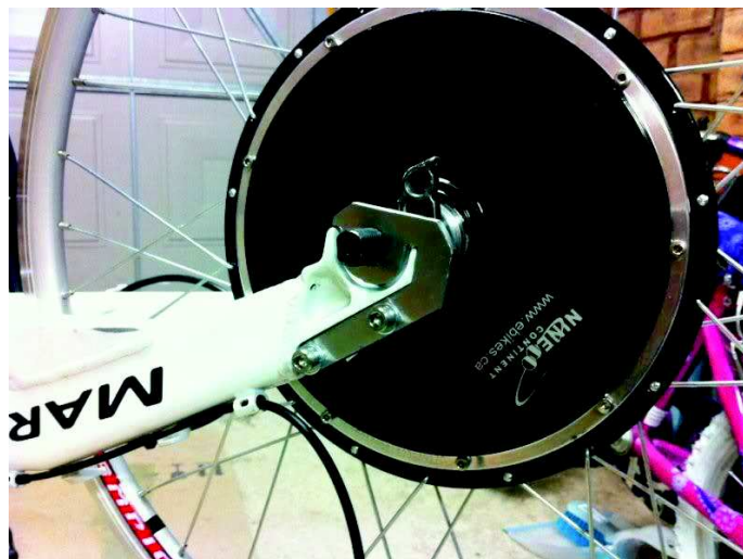
Figura 5.13. Ejemplo de uso de un “torque arm” o abrazadera de sujeción en un motor Hub
