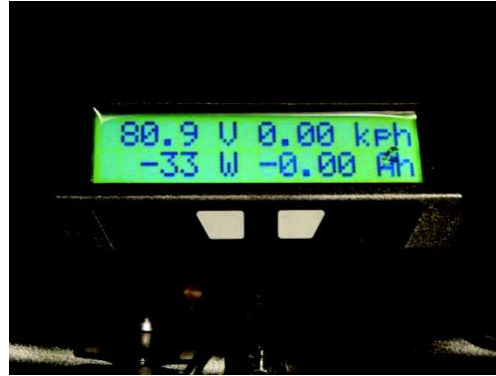
Figura 6.37: CycleAnalyst en funcionamiento, mostrando datos del voltaje, velocidad en kilómetros por hora, vatios y amperios por hora.
