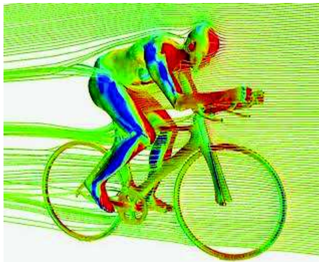
Figura 6.8. Imagen de la circulación del aire a través del ciclista y la turbulencia generada
