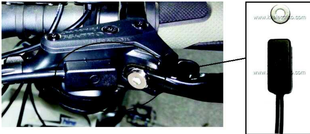
Figura 6.44: Sensores de freno colocados en las manetas de frenos hidráulicos
