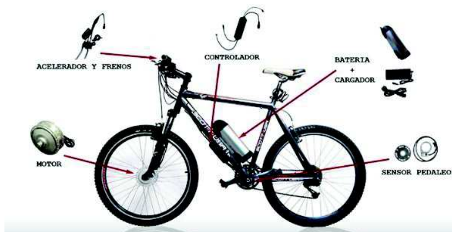
Figura 4.1. Componentes de una E-bike
