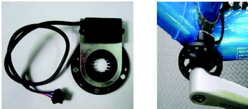
Figura 6.41: A la izquierda, sensor PAS compuesto de disco y sensor Hall. A la derecha, la disposición del sensor una vez colocado en el pedalier de la bicicleta
