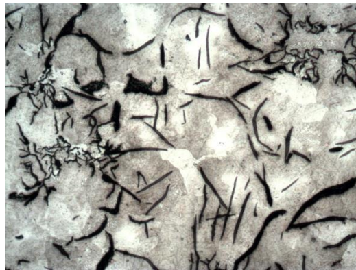
Fig 35. Estructura ferrítico-perlítica de la fundición gris a 200 aumentos.
