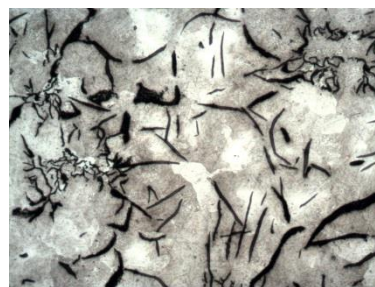
Fig 8. Microestructura de una fundición gris ferrítico perlítica.
