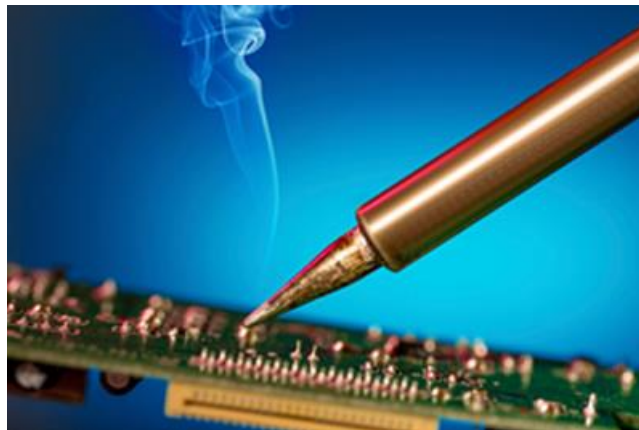
Figura 18. Aplicación de la soldadura blanda.
