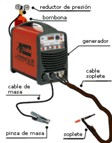
Fig 26. Equipo de soldadura TIG
