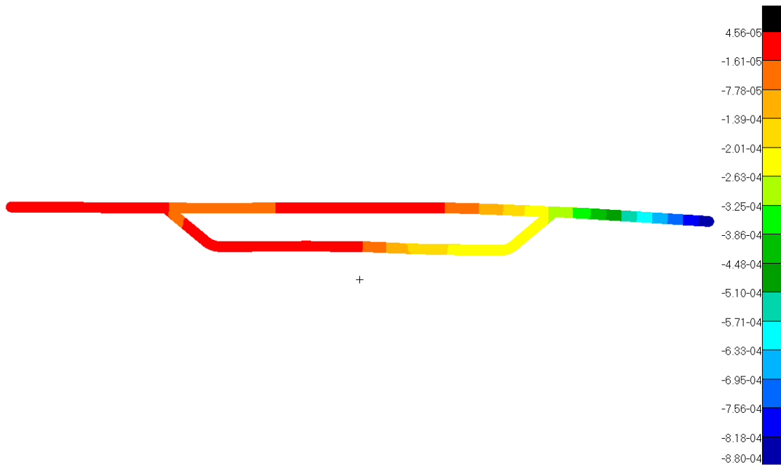
Ilustración 70. Vista lateral de desplazamientos en eje Y
