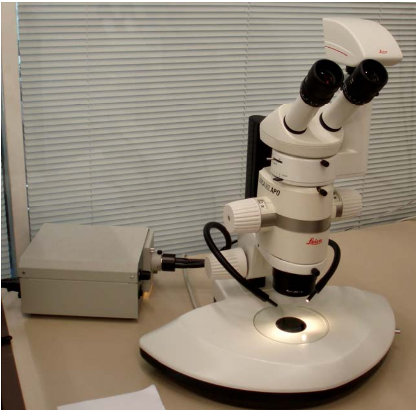
Figura III. 4. Lupa binocular utilizada en la observación y toma fotográfica de las masillas ensayadas tras los distintos envejecimientos acelerados y de la unión de las mismas con respecto a la cerámica.
