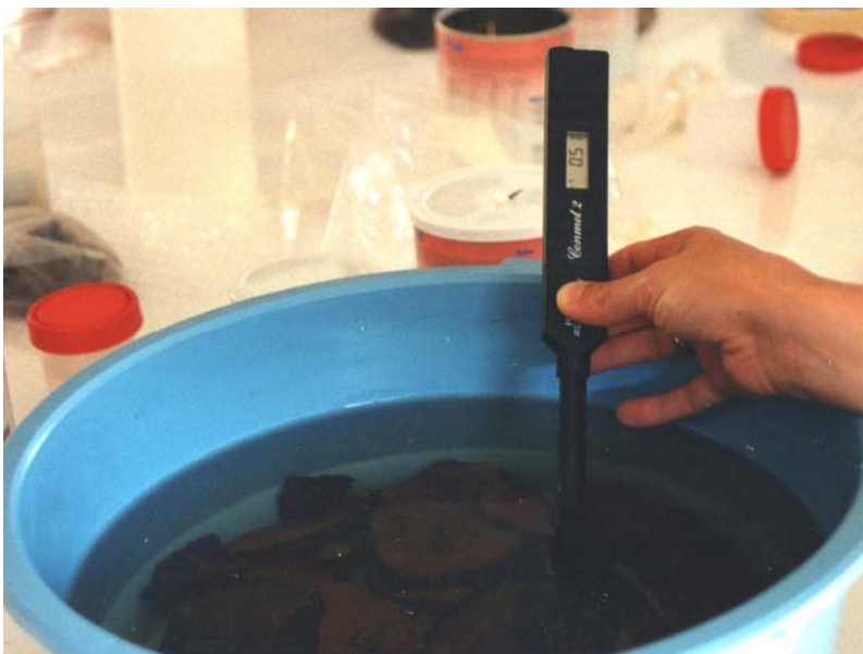
Figura. I.2. Medición de la conductividad del agua en el proceso de eliminación de sales solubles.
