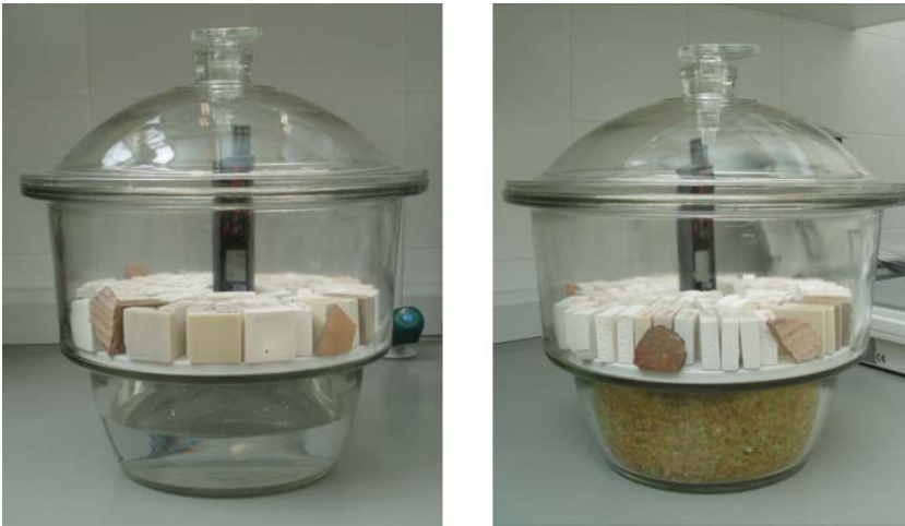
Figuras III. 6 y 7. Cámara de humedad y desecación creadas para el ensayo de envejecimiento acelerado de humidificación y secado.
