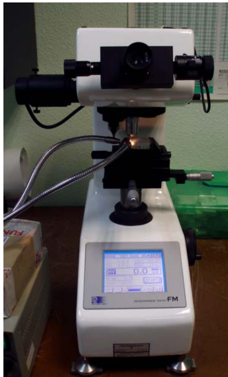
Figura III. 2. Microdurómetro utilizado en la toma de valores de dureza de las masillas tras los ensayos de envejecimiento acelerado.
