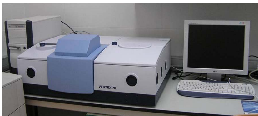
Figura III. 5. Espectrómetro Infrarrojo utilizado en el análisis de las masillas antes y después de ser ensayadas tras los envejecimientos acelerados.
