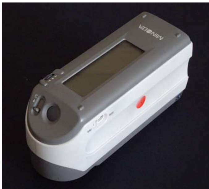
Figura III. 1. Espectrofotómetro Minolta CM-2600d utilizado en la toma de datos espectrales y coordenadas cromáticas.
