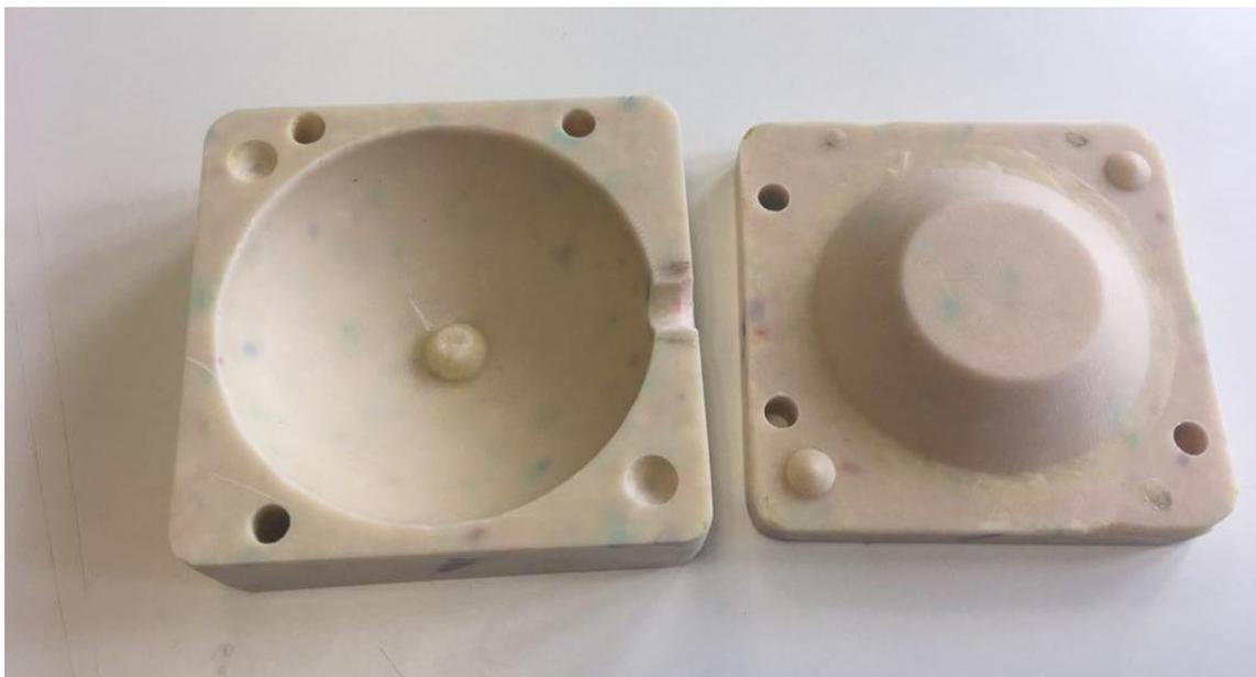
Figura 95. Molde de la pieza interior.
