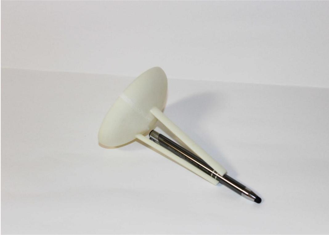
Figura 83. Pieza con 3 patas de sujeción impresa en 3D para probar el diseño.
