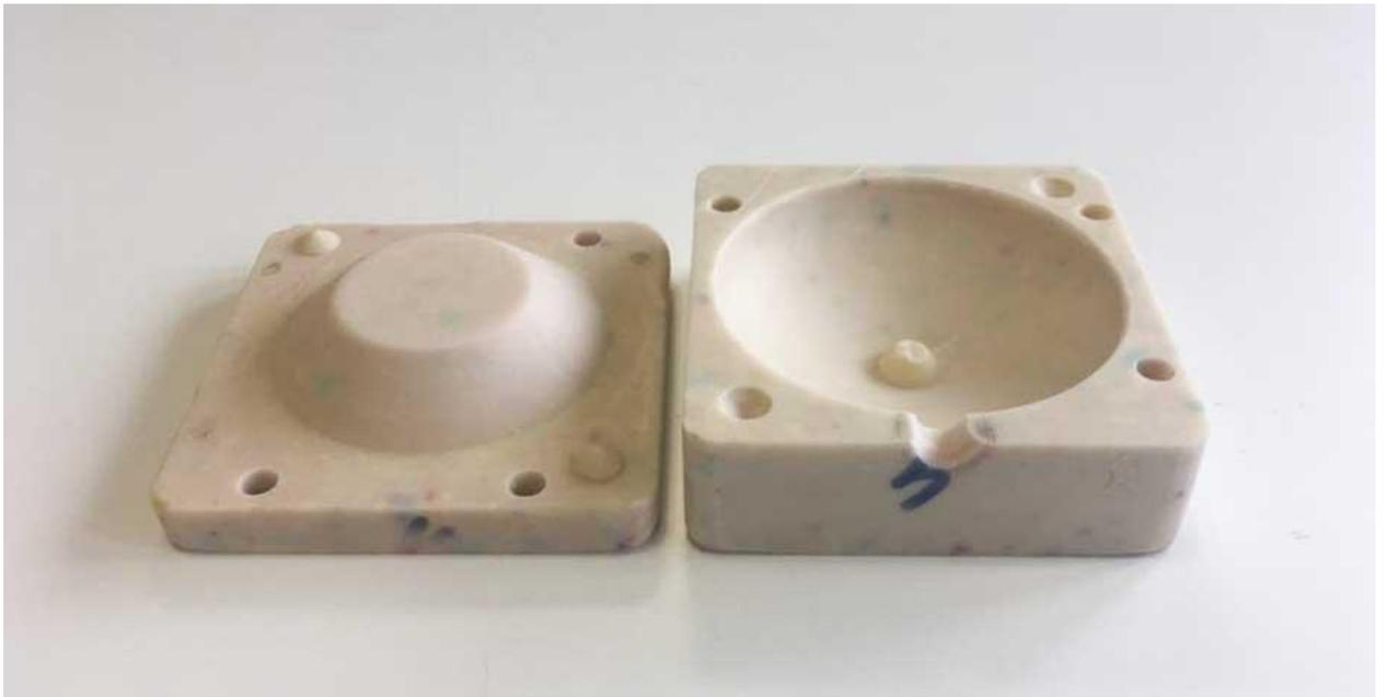
Figura 94. Molde de la pieza interior.
