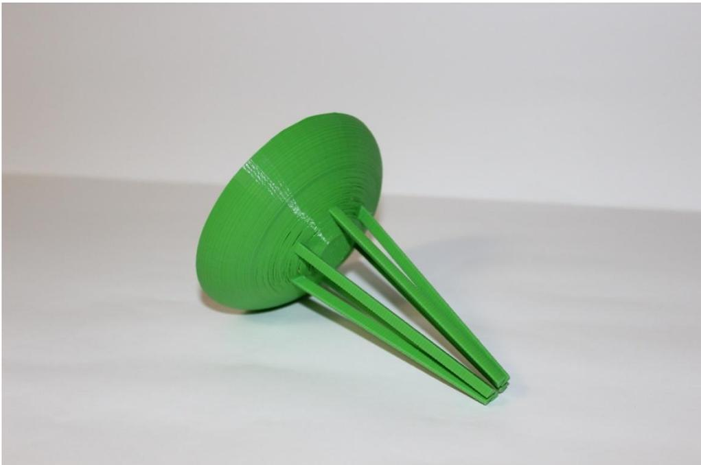
Figura 82. Pieza con 6 patas de sujeción impresa en 3D para probar el diseño.
