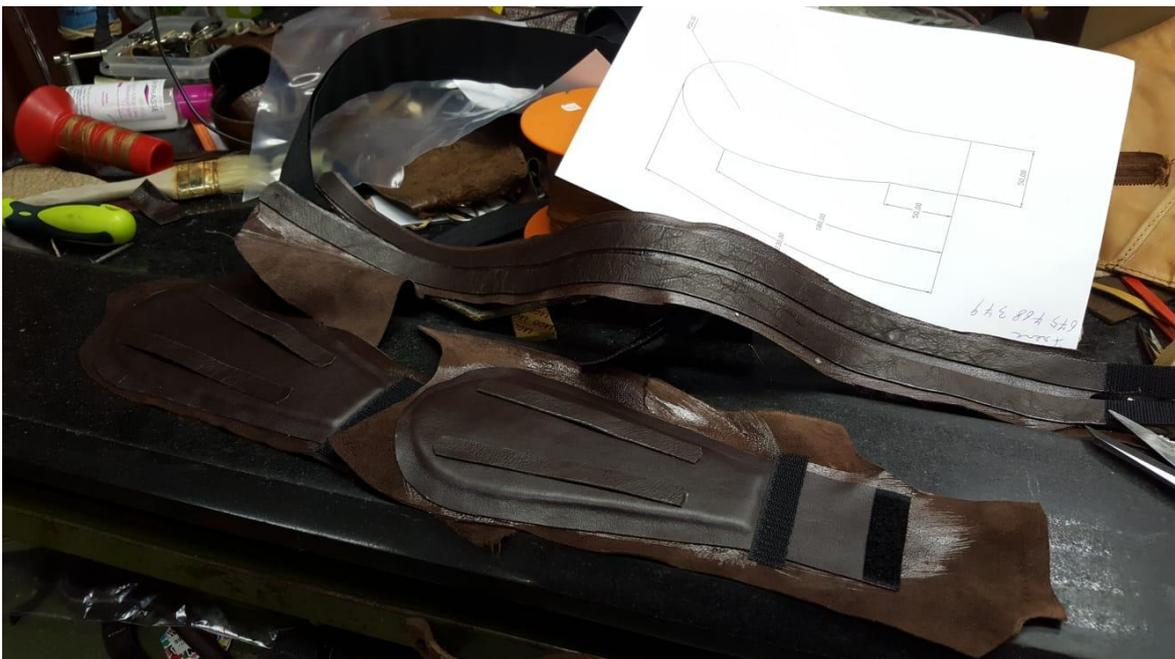
Figura 76. Velcro en el prototipo que permite la adaptación de las piezas.
