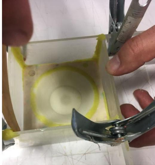
Figura 92. Preparación segunda parte del molde.
