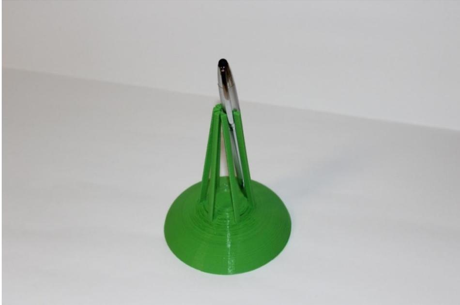
Figura 81. Pieza con 6 patas de sujeción impresa en 3D para probar el diseño.
