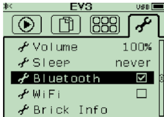
Figura 42. Activación del bluetooth en la EV3.
