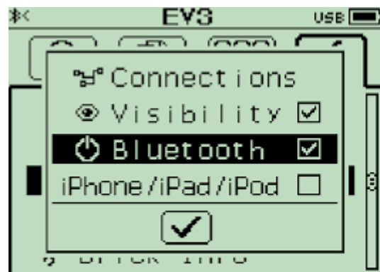
Figura 43. Ajustes para activar el bluetooth en la EV3.
