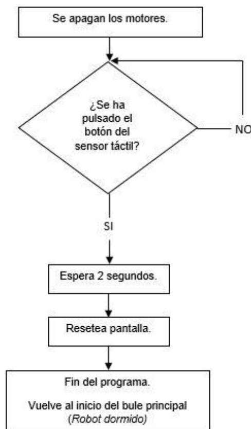
Figura 21. Diagrama de flujo de la tercera parte del control de estabilidad.
