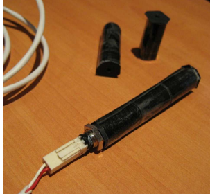
Figura 6.8: Cámara estenopéica usada en cada fototransistor.
