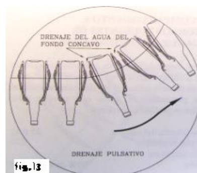
FIGURA 3.10 Esquema del drenaje del agua de las botellas.
