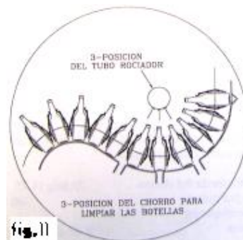
FIGURA 3.8 Posición del chorro para limpieza de botellas.
