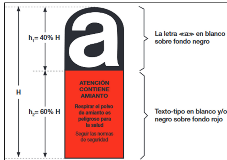
Ilustración 22 - Etiqueta reglamentaria de identificación de materiales con amianto.
