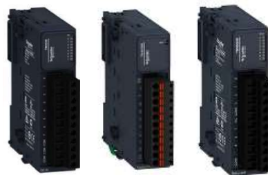
Detalle 8b. Módulos de expansión PLC. De izquierda a derecha 1. Módulo 8 entradas digitales, 2. Módulo 2 salidas analógicas, y 3. Módulo 8 salidas digitales relé.
