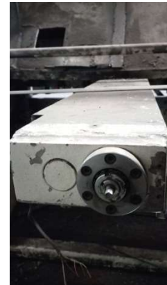
Detalle 4. Extremo del tornillo sinfín donde integraremos el encoder.
