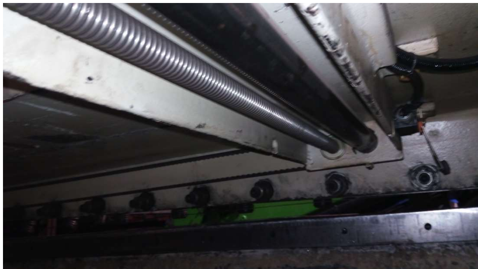
Detalle 2. Transmisión tornillo sinfín del tope de corte longitudinal – Parte inferior del mecanismo de posicionamiento del tope. Se puede distinguir al fondo la correa dentada que transmite el movimiento entre los dos tornillos.
