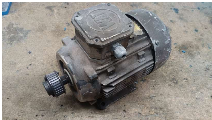
Detalle 3. Motor original averiado y el engranaje de transmisión – se sustituirá por un motor de idénticas características del fabricante ABB. (ver hojas de características en anexo).
