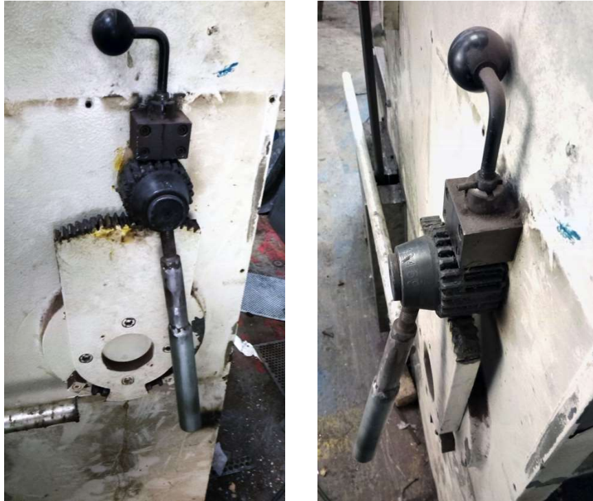
Detalle 11. Palanca de ajuste de centella que se pretende automatizar neumáticamente.
