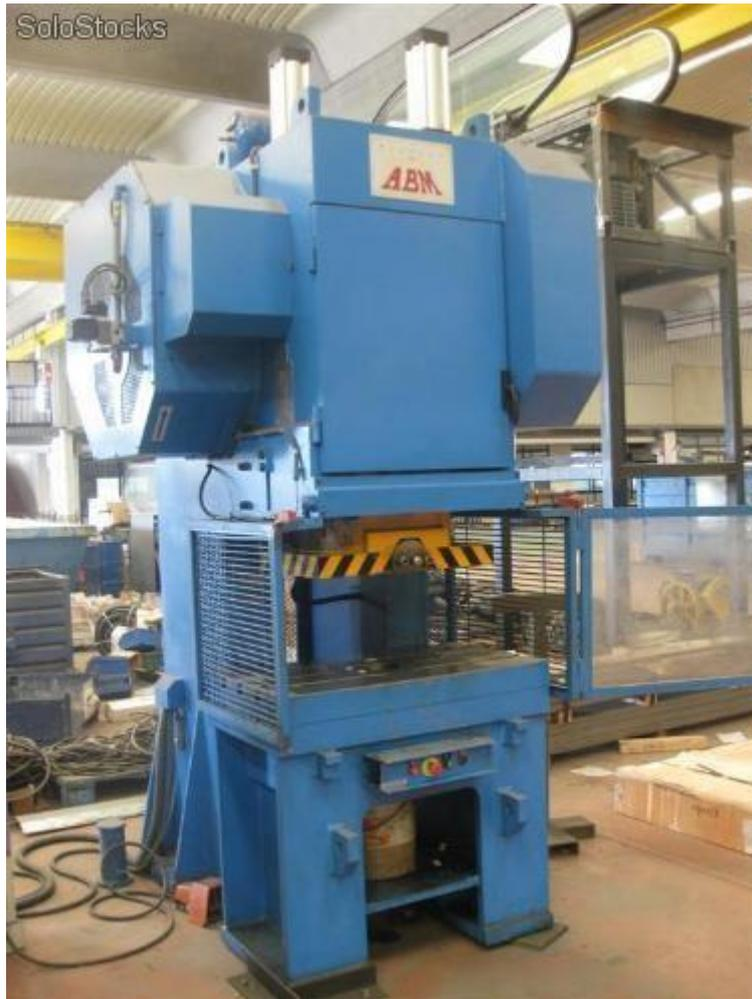
*Figura 17. Prensa de accionamiento mecánico*
