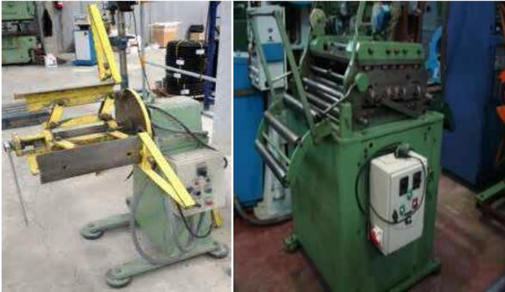
*Figura 12. Maquinaria que compone el alimentador automático*
