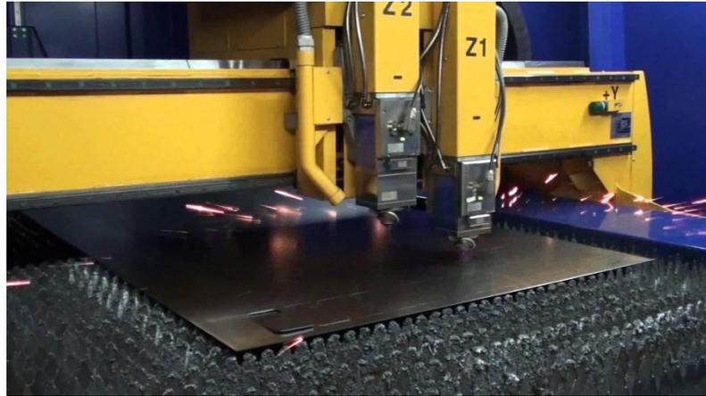
*Figura 4. Máquina de corte por láser*
