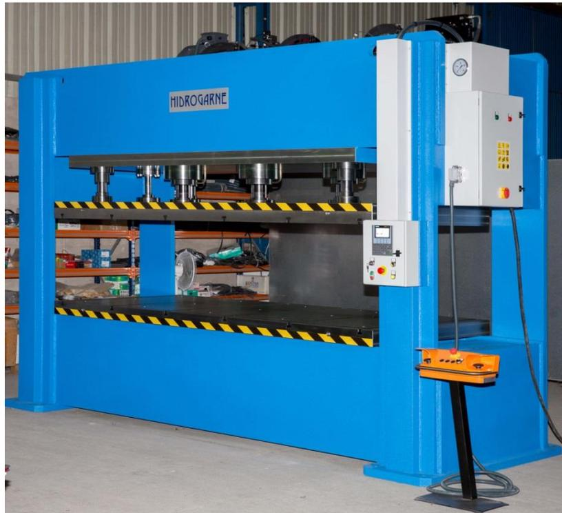
*Figura 18. Prensa de accionamiento hidráulico*
