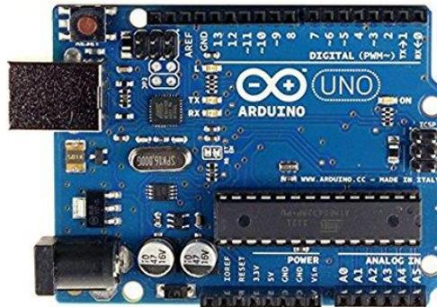
Figura 19. Microcontrolador Arduino UNO
