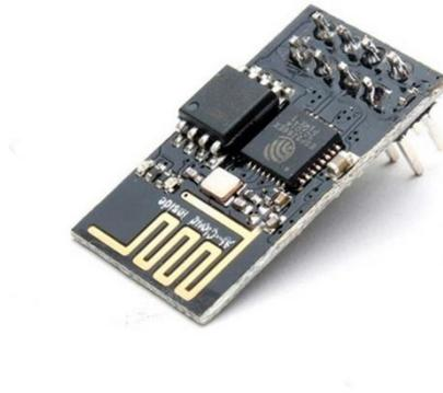
*Figura 23. Módulo ESP8266*
