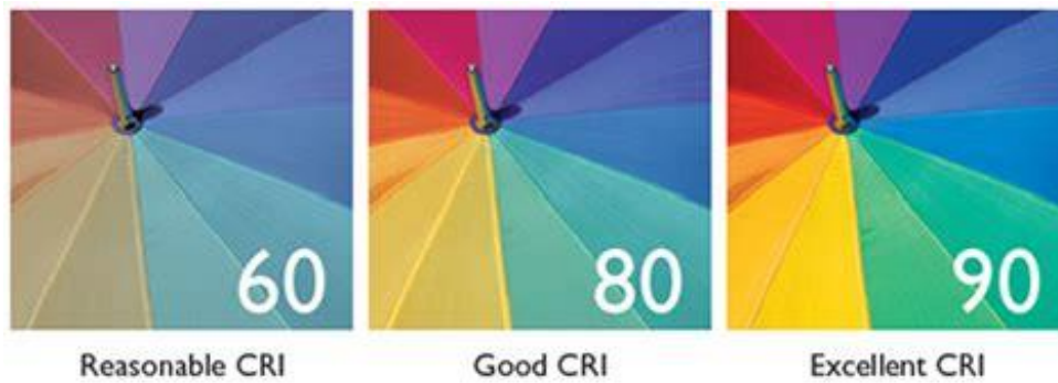
Ilustración 3: Comparación de los rendimientos cromáticos correspondientes a distintos IRC. (Philips Lighting, 2018)
