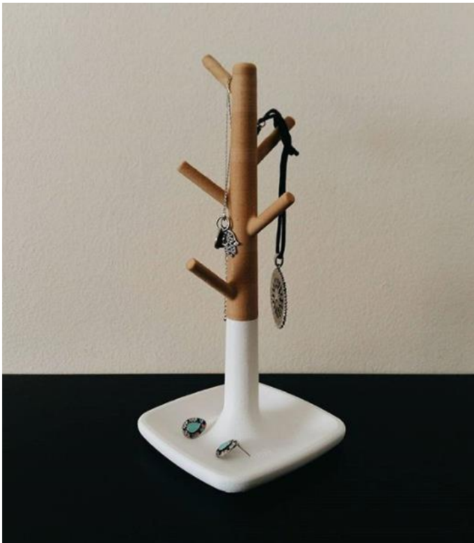
Fig. 28. Impresión 3D con madera y PLA. Elaboración propia
