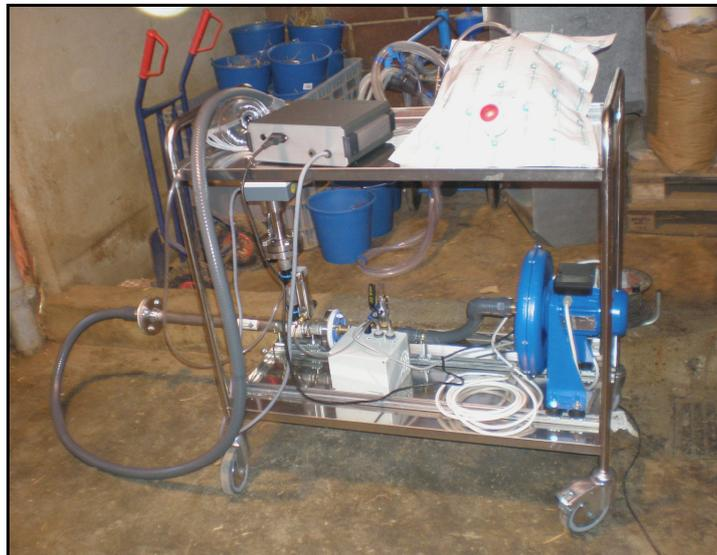
Tras los 10 minutos de recogida de aire expirado, la bolsa se cerraba herméticamente y se llevaba al laboratorio, donde se conectaba a un analizador de gases (Easyflow 3020, ABB S.A.) con cubetas de calibración incorporadas para medir concentraciones de oxígeno, dióxido de carbono y metano.
