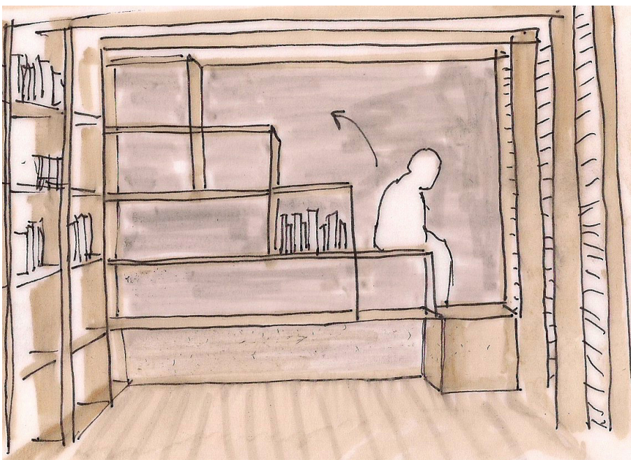
FIGURA 324. Dibujo detalle estanterías entre ejes de estructura y escaleras multiusos. Elaboración propia
