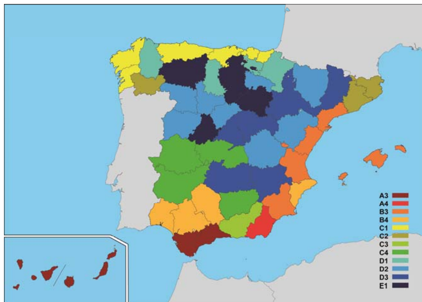
Figura 3.2.- Zonas climáticas de capitales provinciales (no toda la provincia se adscribe a la misma zona climática, al estar también condicionado por la altitud)
