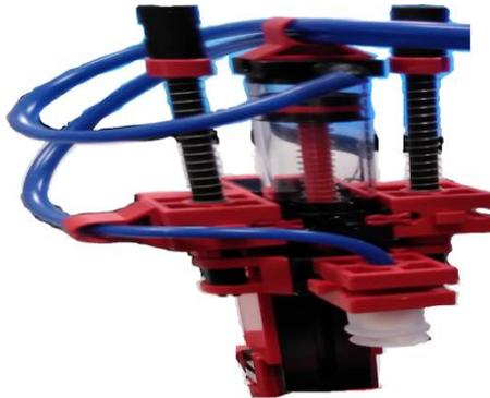
[Imagen 76: Manipulador de aspiración con ventosa de succión al vacío.](#)
