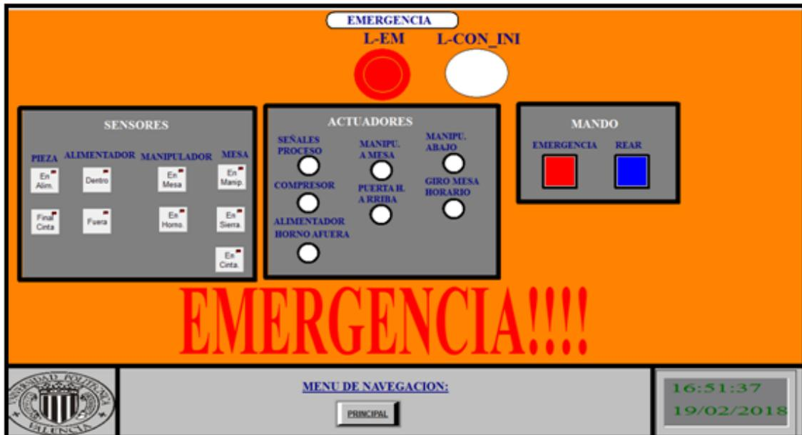
[Imagen 49: Sinóptico pantalla "Emergencia" situación de emergencia, sistema SCADA.](#)
