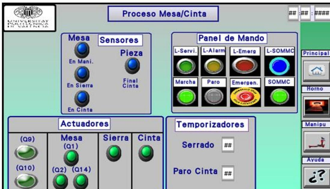
Imagen 60: Sinóptico pantalla "Proceso manual mesa/cinta" HMI.
