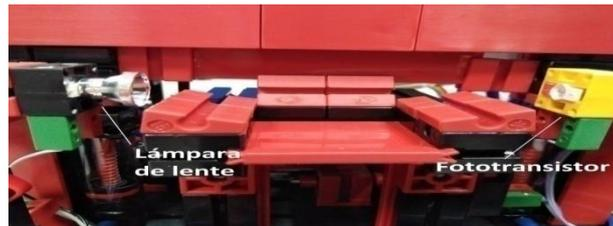
[Imagen 66: Fototransistor con lámpara de lente.](#)
