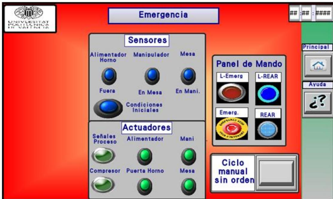
[Imagen 53: Sinóptico pantalla "Emergencia" HMI.](#)
