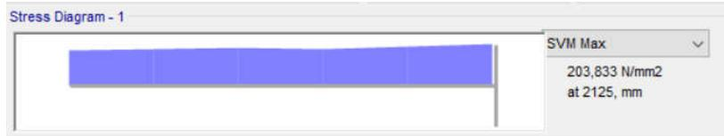
Ilustración 32. Tensión máxima de Von Mises (SAP2000).
