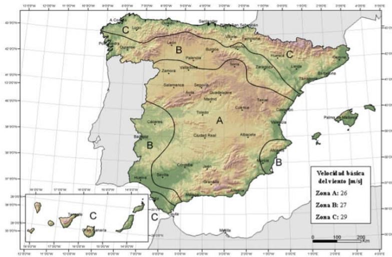
Ilustración 11. Figura D.1 Valor básico de la velocidad del viento,  $v_b$ .
