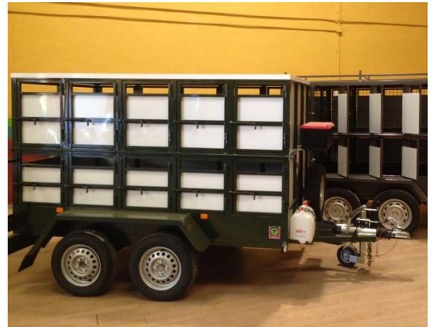
*Ilustración 5. 2 pisos 2 ejes separadores y cajón delantero.*
