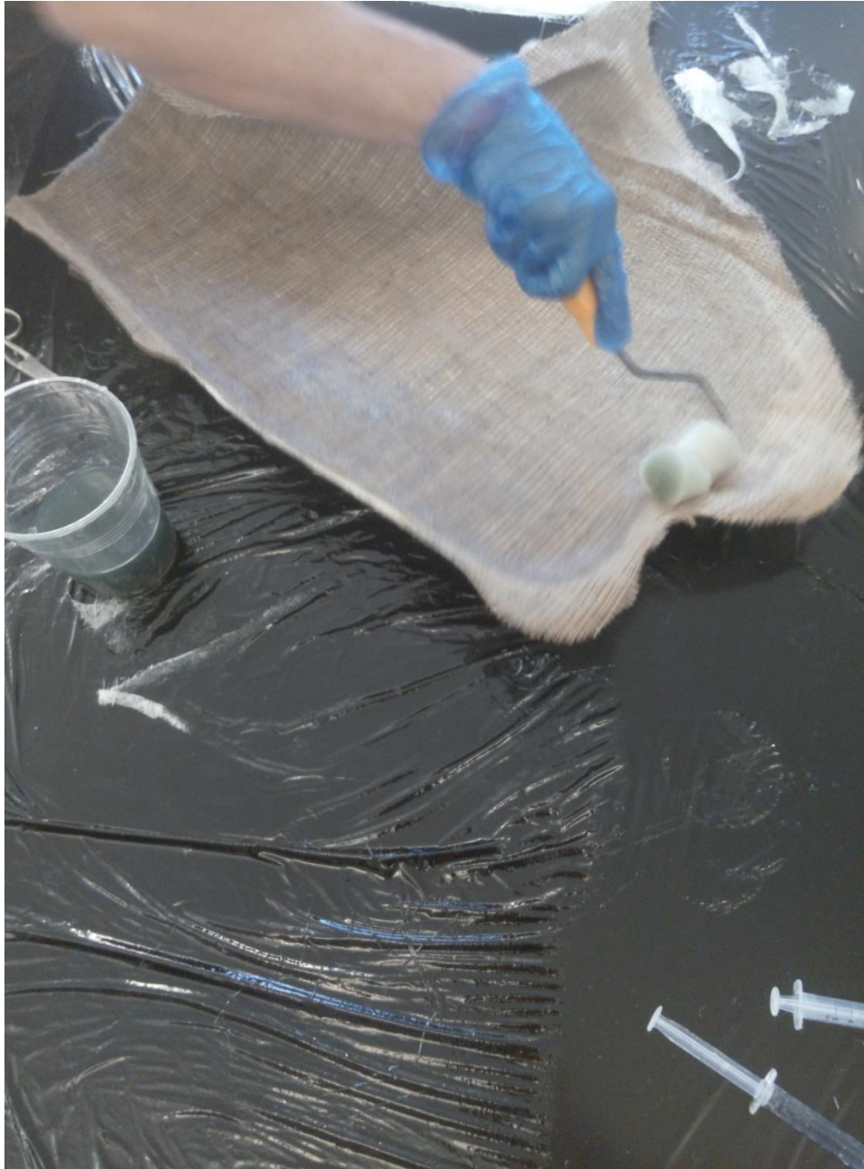
Figura 6.3.- Aplicación de la fibra sobre el molde (I)
