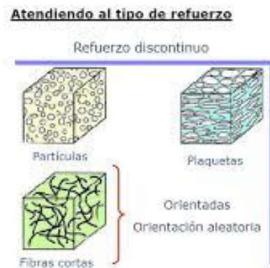
Figura 2.1.- Refuerzos discontinuos, a) partículas, b) fibras discontinuas c) plaquetas
