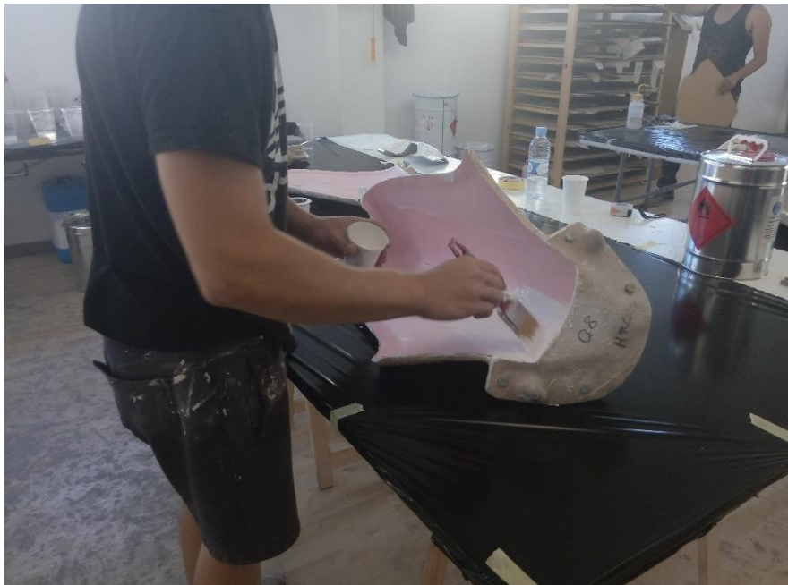
Figura 6.1.- Aplicación de la capa de gelcoat
