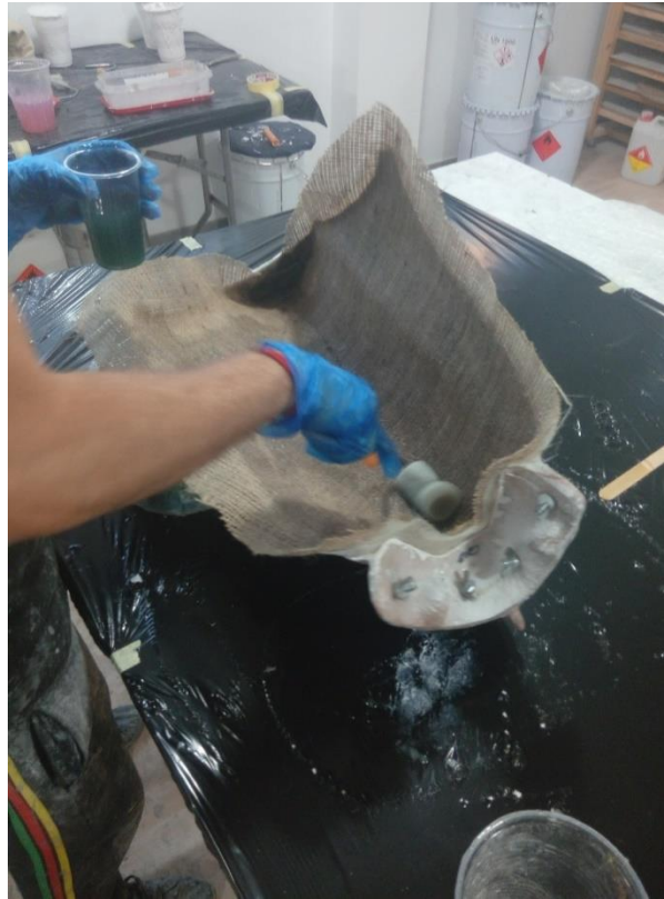
Figura 6.4.- Aplicación de fibra sobre molde (II)
