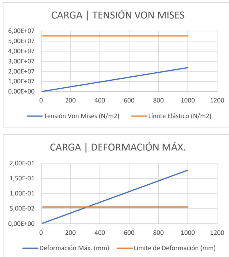
Ilustración 12-8 Gráficas deformación y tensiones frente a la carga aplicada
