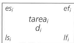
Figura 3. Tiempos es_i , ef_i , ls_i e lf_i del Nodo i correspondiente a la tarea i con duración d_i
