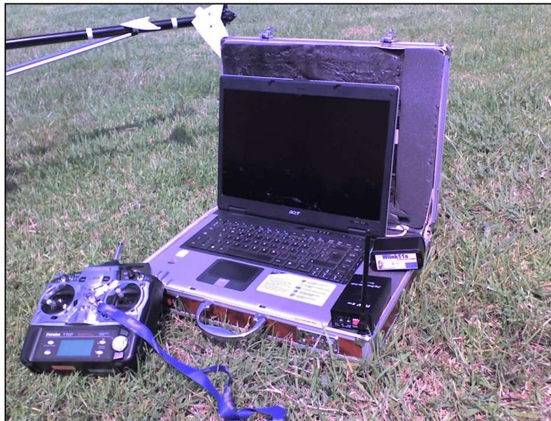
(a) **En la Estación Base: En la Estación Base:** El ordenador se abre el programa simulador de vuelos COMPEGPS AIR, quién registra los eventos del vuelo mediante un video del vuelo con datos de telemetría y un registro de datos tipo mensaje NMEA, que recibido por el transceptor Wlink11s.
