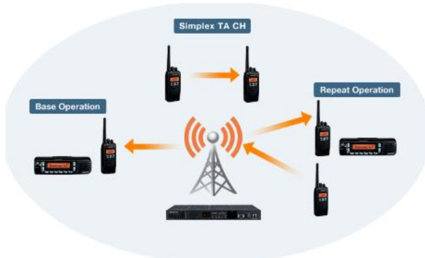
Fig.1. Estructura básica de una red PMR. [2]
