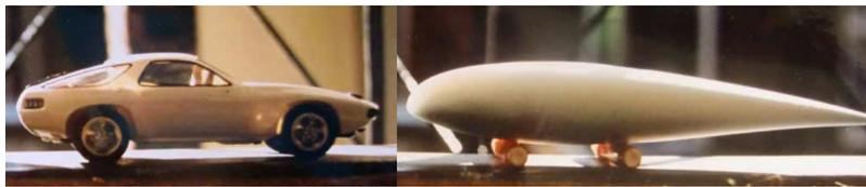
Figura 2.31: Porsche 928 en posición invertida junto a la forma aerodinámica óptima.
