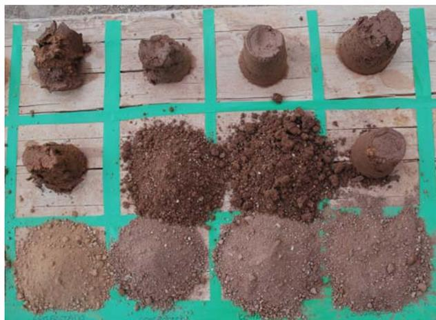
Figura 3.7. Test Carazas, empleado para comprobar empíricamente el comportamiento de una muestra de tierra puesta en obra con diferentes grados de humedad y compactación.
