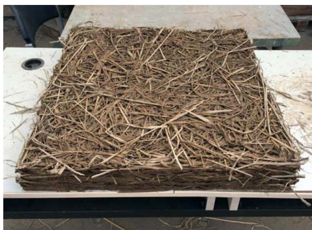
Figura 3.20. Panel de aislamiento de tierra aligerada con paja ensayado en las instalaciones de la Pontificia Universidad Católica del Perú.
