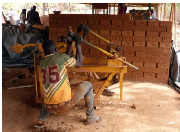
Figura 3.16. Producción manual de BTC en una fábrica de Uagadugú, Burkina Faso.
