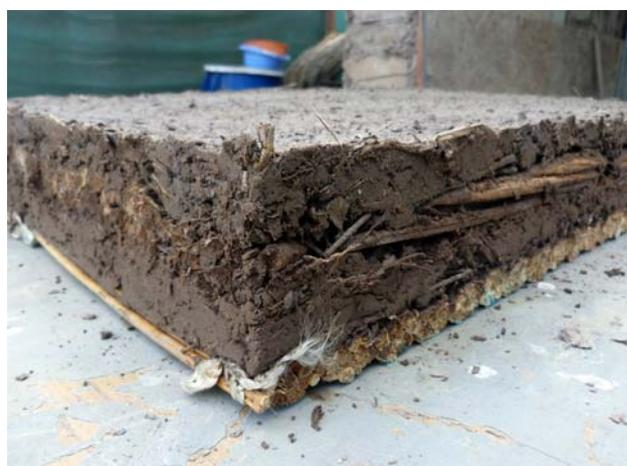
Figura 3.21. Panel autoportante de tierra aligerada con paja y soporte de totora ensayado en las instalaciones de la Pontificia Universidad Católica del Perú.
