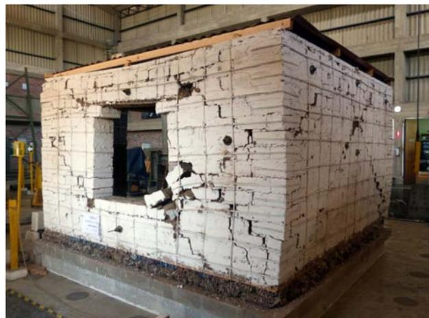
Figura 3.23. Módulo de vivienda de adobe reforzado con sogas sintéticas y cimentación flexible ensayado en el laboratorio de estructuras sismorresistentes de la Pontificia Universidad Católica del Perú.
