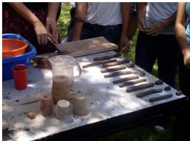
Figura 3.8. Prueba de cinta de barro, empleada para comprobar empíricamente el adecuado contenido de arcilla de una muestra.
