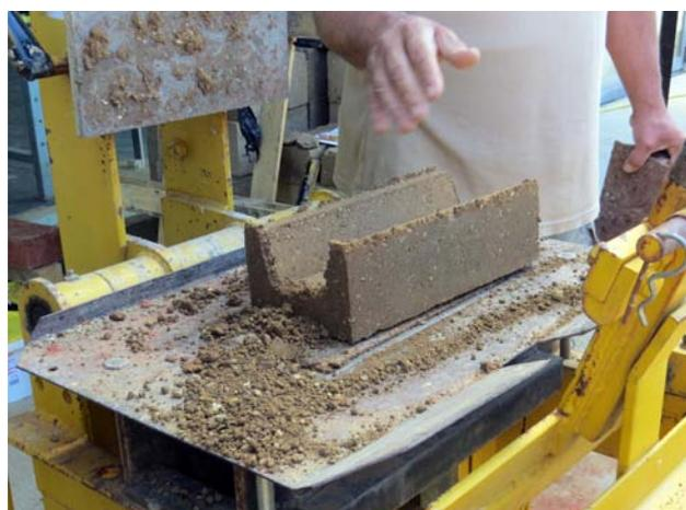
Figura 3.17. Fabricación de un BTC con canal para la construcción de fábricas armadas.
