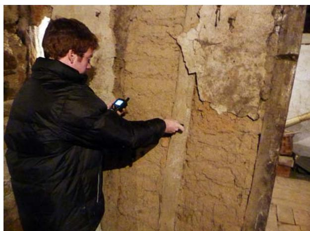
Figura 6.3. Comprobación del contenido de humedad de un entramado mediante un higrómetro.
