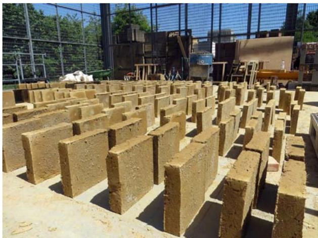
Figura 5.12. Adobes dispuestos en vertical para su secado por ambas caras. En ocasiones, las piezas se colocan en diagonal para evitar que una pieza, al volcar, pueda empujar al resto de su fila.
