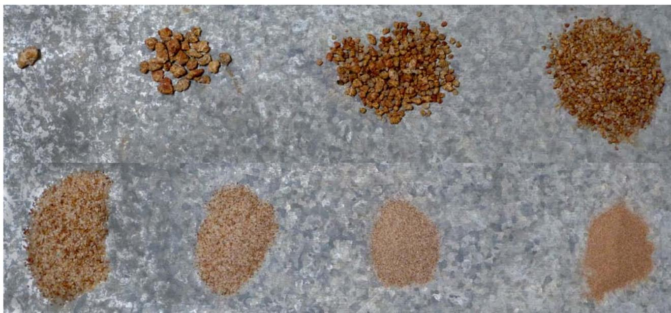
Figura 3.4. Diferentes diámetros de gravas y arenas contenidas en una muestra de tierra. Los resultados se han obtenido por tamizado normalizado de la muestra, que previamente había sido lavada para eliminar las arcillas y limos contenidos en ella.
