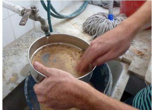
Figura 3.6. Lavado de una muestra de tierra para la eliminación de limos y arcillas. Este proceso debe realizarse antes del tamizado de la tierra durante su análisis granulométrico.
