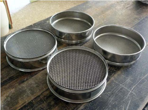
Figura 3.5. Tamices normalizados empleados para la clasificación de los áridos de una muestra de tierra durante su análisis granulométrico.
