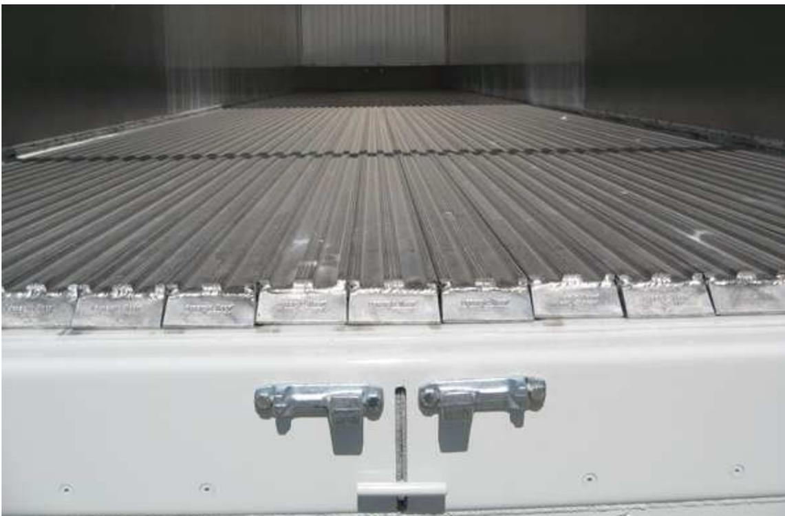
*Figura 4.15: Fotos del piso móvil usado en la planta de transferencia de Caudete de las Fuentes*
