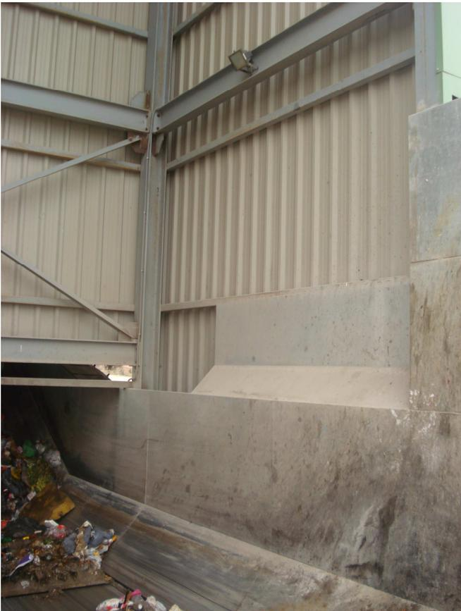
Se ven: los pivotes añadidos en la estructura metálica para que los recolectores no se metan dentro de la cinta; y las piñas de luz en los laterales para facilitar el trabajo nocturno.
