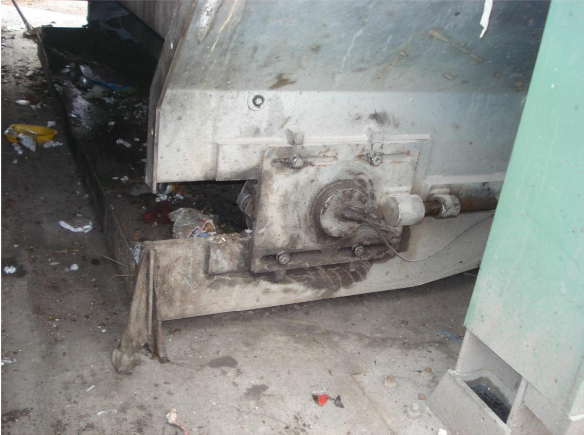
Se ven: el sistema de recogida de los RSU que vuelven por la cinta transportadora; y el mecanismo para controlar el tensado/destensado de la cinta transportadora
