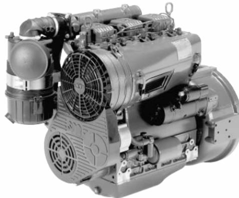
*Figura 4.4: Ilustración del Motor VM SUN 3105*
