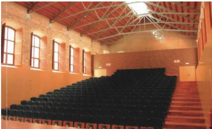
Figura 132 – Vista del interior de sala polivalente, donde se aprovecha la estructura de la cubierta para proveer iluminación cenital al ambiente. (Fuente: TC Cuadernos nº 61, 2004)
