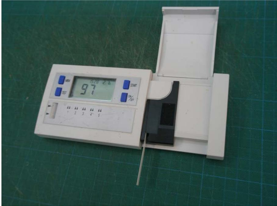
**Fotografía 7.** Reflectómetro para la medición de nitratos
