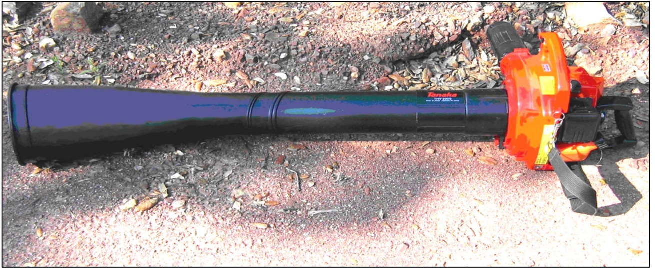
Figura 10: Aspirador de hojas adaptado para el muestreo
