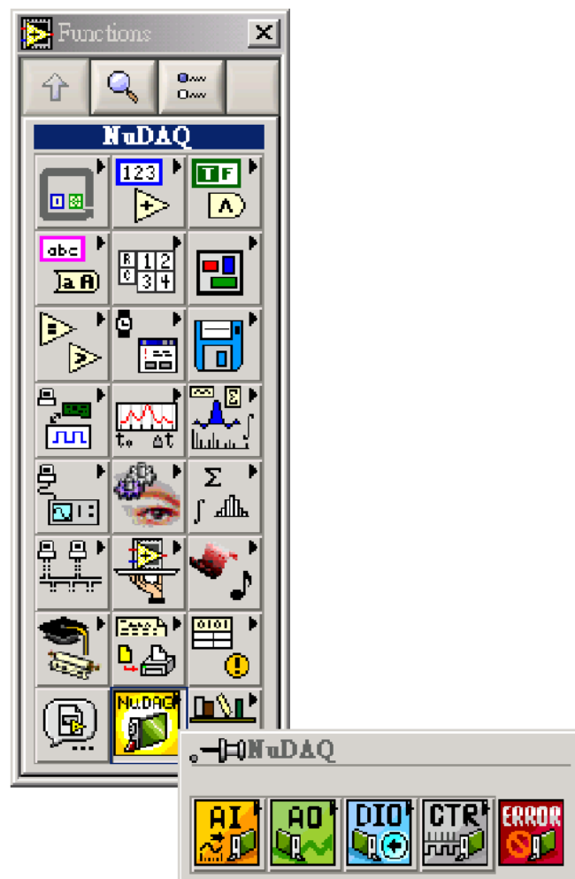
Figura 3.6: Bloques VI para acceso a las DAQ
