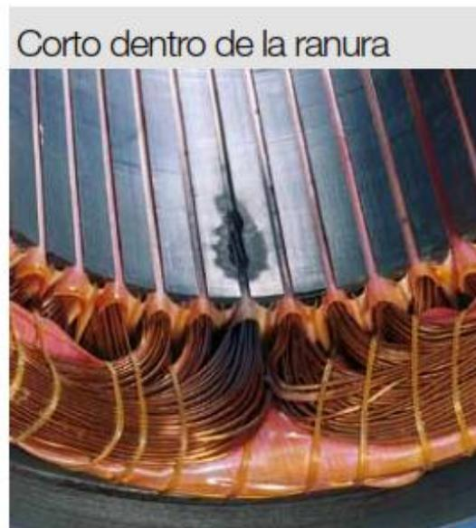
Figura 28. Fallos en los bobinados de motores trifásicos [7].
