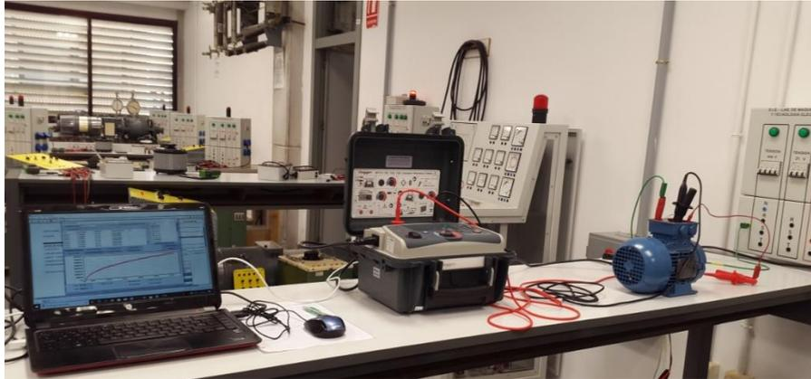
Figura 18. Medición de PI en un motor eléctrico.
