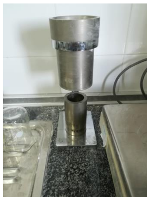
Ilustración 28. Imagen ensayo densidad aparente del \text{CaCO}_3
