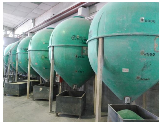
Ilustración 24. Silos esféricos de 10m 3
