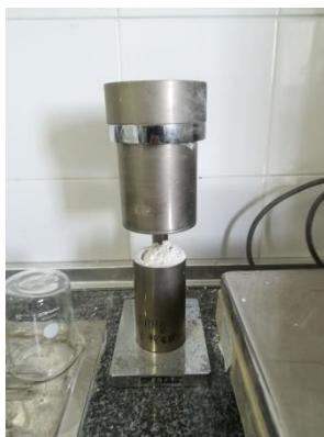
Ilustración 29. Imagen ensayo densidad aparente del \text{CaCO}_3
