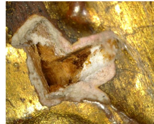
Fig. 54 Orificio carcoma con microscopio USB
