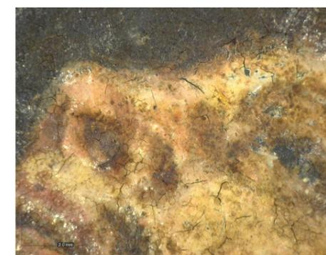
Fig. 47 Grietas tomadas con microscopio USB
