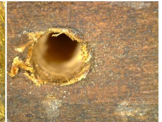
Fig. 55 Orificio de carcoma con microscopio USB
