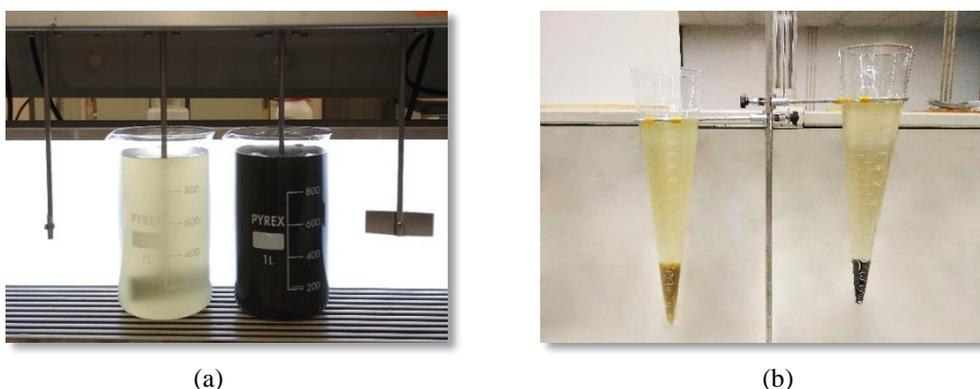
Figura 5.32. (a) Jar-Test y (b) sedimentación en cono Imhoff para ensayo con fango rechazo.
