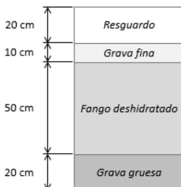
Figura 6.1. Distribución en profundidad de las capas del medio granular.
