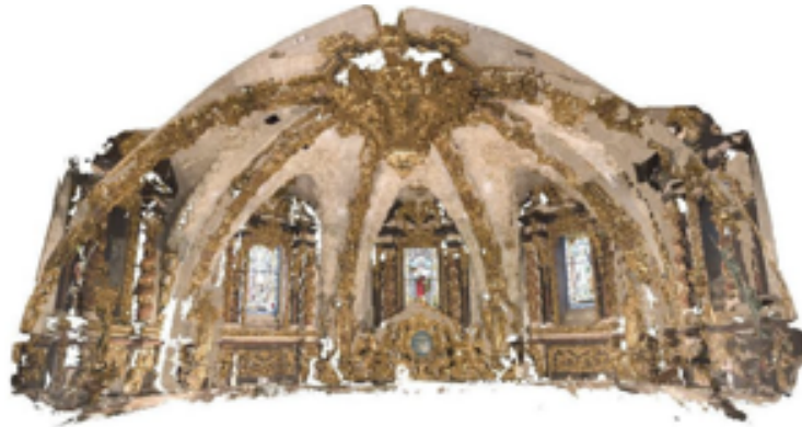
Fig. 25 Modelo 3D de la bóveda barroca obtenido con un láser escáner terrestre.
