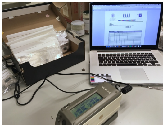
FIGURA 7. Espectrofotómetro CM-2000d de KONICA MINOLTA®.
