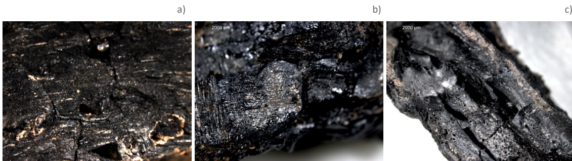
FIGURA 19. BT-P-P. Microfotografías adquiridas con lupa binocular a 10X. a) Antes de la consolidación, en superficie. b) Después de la consolidación, en superficie. c) Después de la consolidación, en sección transversal.
