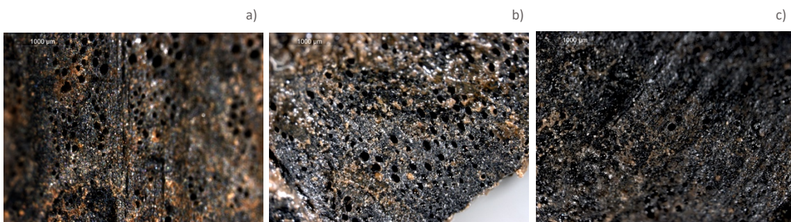
FIGURA 20. PB72-I-P. Microfotografías adquiridas con lupa binocular a 25X. a) Antes de la consolidación, en superficie. b) Después de la consolidación, en superficie. c) Después de la consolidación, en sección transversal.
