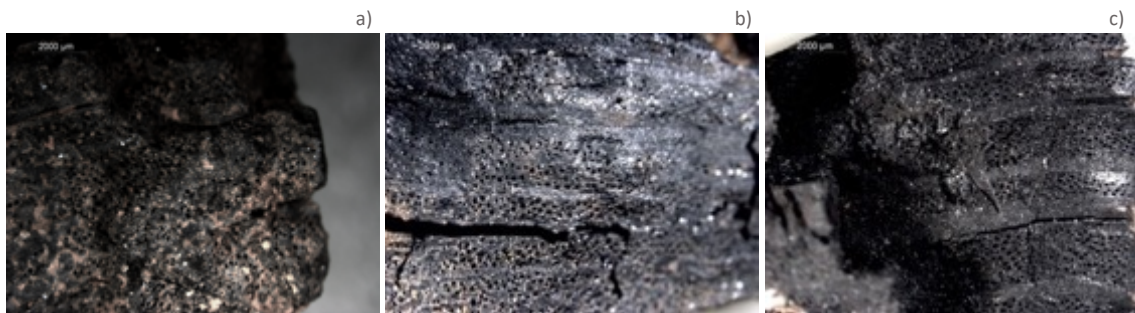
FIGURA 48. Muestra BT-I-P, fotografías tomadas con Lupa Binocular a 10X. a) Antes de la consolidación, en superficie. b) Después de la consolidación, en superficie. c) Después de la consolidación, en sección transversal.
