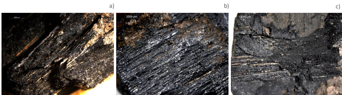
FIGURA 17. Muestra M30-I-P, microfotografías adquiridas con lupa binocular a 10X. a) Antes de la consolidación, en superficie. b) Después de la consolidación, en superficie. c) Después de la consolidación, en sección transversal.
