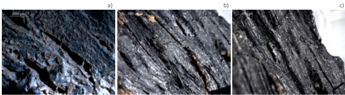
FIGURA 47. Muestra M50-I-P, fotografías tomadas con Lupa Binocular a 10X. a) Antes de la consolidación, en superficie. b) Después de la consolidación, en superficie. c) Después de la consolidación, en sección transversal.
