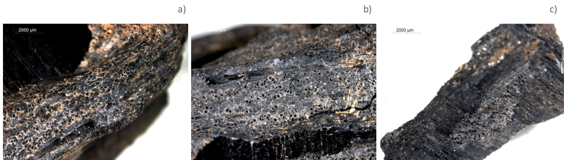
FIGURA 16. M20-I-P. Microfotografías adquiridas con lupa binocular a 10X. a) Microfotografía antes de la consolidación, en superficie. b) Microfotografía después de la consolidación, en superficie. c) Microfotografía después de la consolidación, en sección transversal.
