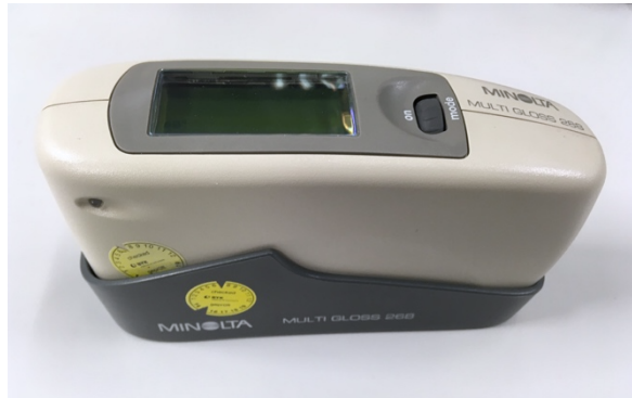
FIGURA 8. Medidor de brillo Multi Gloss 268 de KONICA MINOLTA®.
