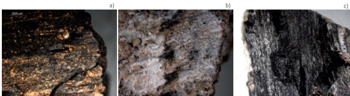
FIGURA 44. Muestra C80-I-P, fotografías tomadas con Lupa Binocular a 10X. a) Antes de la consolidación, en superficie. b) Después de la consolidación, en superficie. c) Después de la consolidación, en sección transversal.
