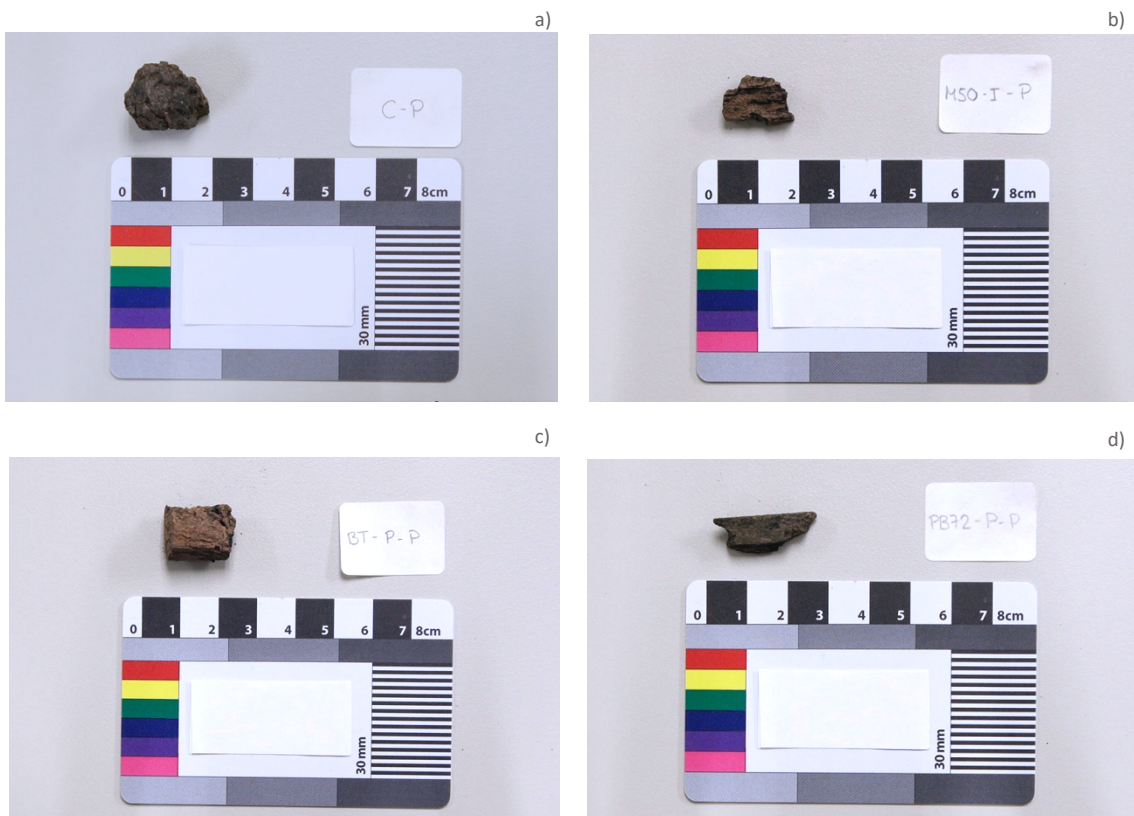
FIGURA 2. Fragmentos de madera carbonizada de origen arqueológico procedentes del Museo Arqueológico de Burriana. a) fragmento control. b) Fragmento usado para ser consolidado por inmersión con Mowilith® 50. c) Fragmento usado para ser consolidado por impregnación con Polivinil butyral. d) Fragmento usado para ser consolidado por impregnación con Paraloid® B-72.
