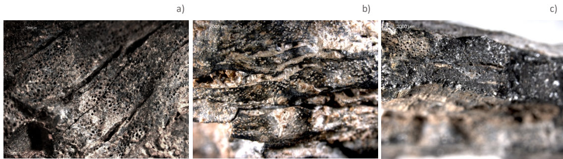
FIGURA 15. Muestra C80-P-P, microfotografías adquiridas con lupa binocular. a) Microfotografía a 12,5X antes de la consolidación, en superficie. b) Microfotografía a 10X después de la consolidación, en superficie. c) Microfotografía a 10X después de la consolidación, en sección transversal.
