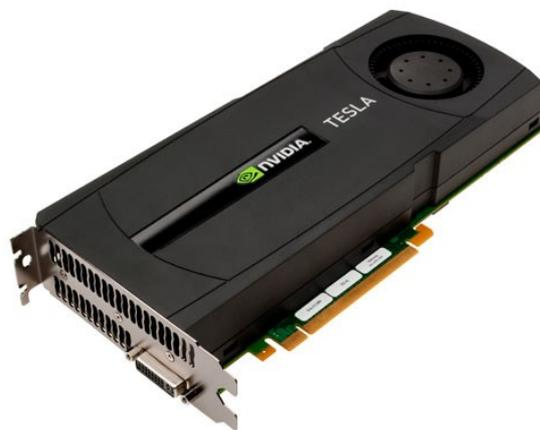
Fig. 6.1 – Tarjeta gráfica NVIDIA TESLA con arquitectura CUDA
