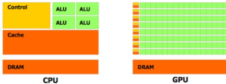
Fig. 6.3 – La GPU dedica más transistores al procesamiento de datos
