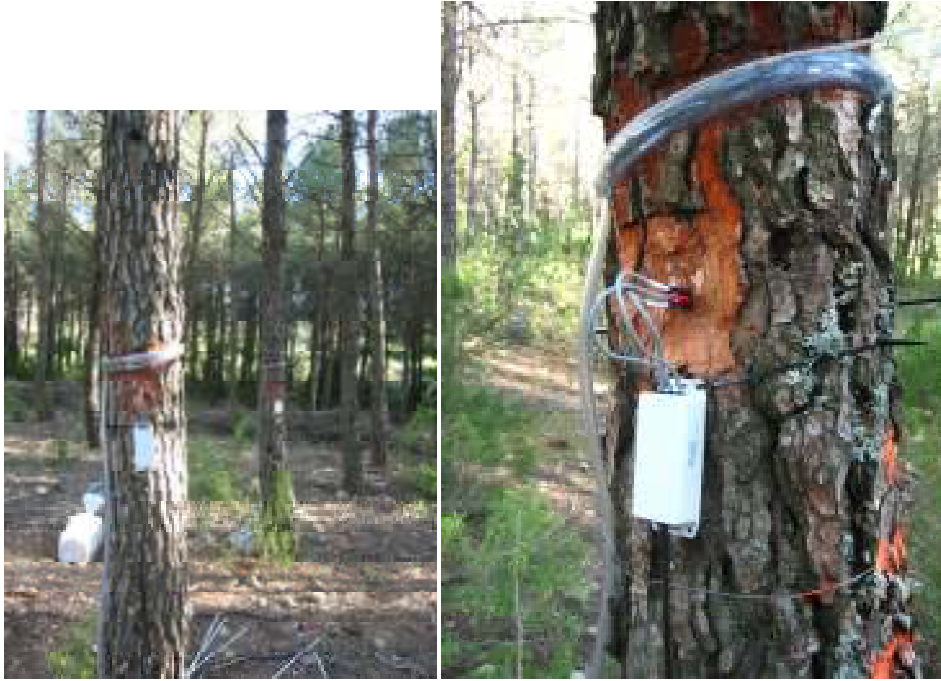
Figura 14. Detalle de la instalación de los sensores de flujo de savia en campo
