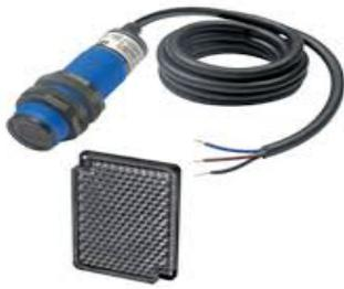
Sensores digitales sin contacto físico. Actúan al ser interrumpido el haz de luz entre un emisor y un receptor (barrera), aunque también los podemos encontrar encapsulados en el mismo envoltorio (reflexión sobre objeto o sobre espejo).
