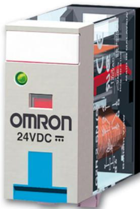
El relé o relevador es un dispositivo electromagnético. Funciona como un interruptor controlado por un circuito eléctrico en el que, por medio de una bobina y un electroimán, se acciona un juego de uno o varios contactos que permiten abrir o cerrar otros circuitos eléctricos independientes.
