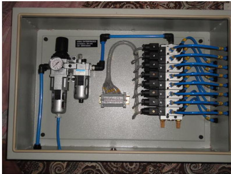
El equipo neumático de control se encuentra dentro de un armario situado sobre el cuadro eléctrico. En el interior de este armario se encuentran todos los elementos de control neumáticos.
