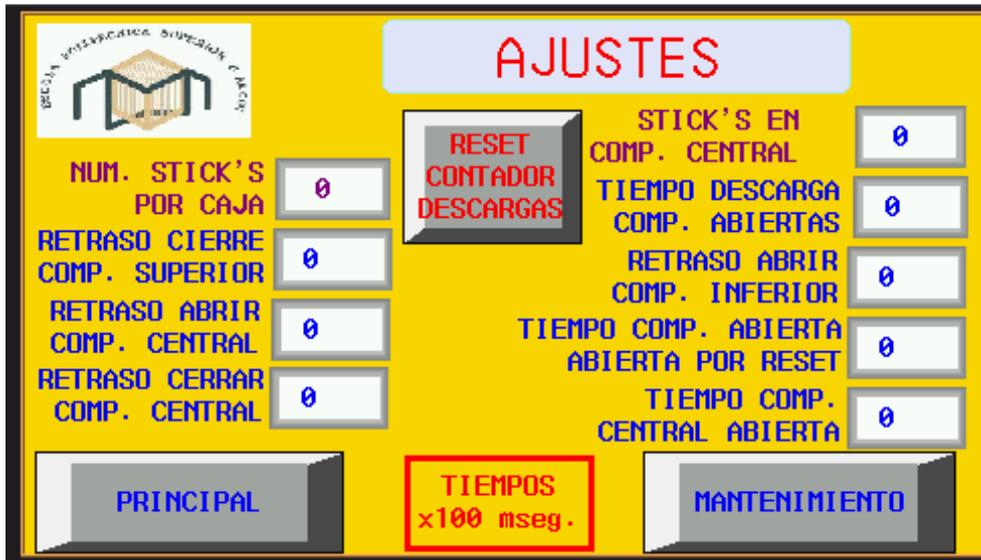
Tanto en la pantalla Principal como en la pantalla de Mantenimiento hay un pulsador que accede a Ajustes, donde se introducen los diferentes parámetros de funcionamiento de la máquina.
