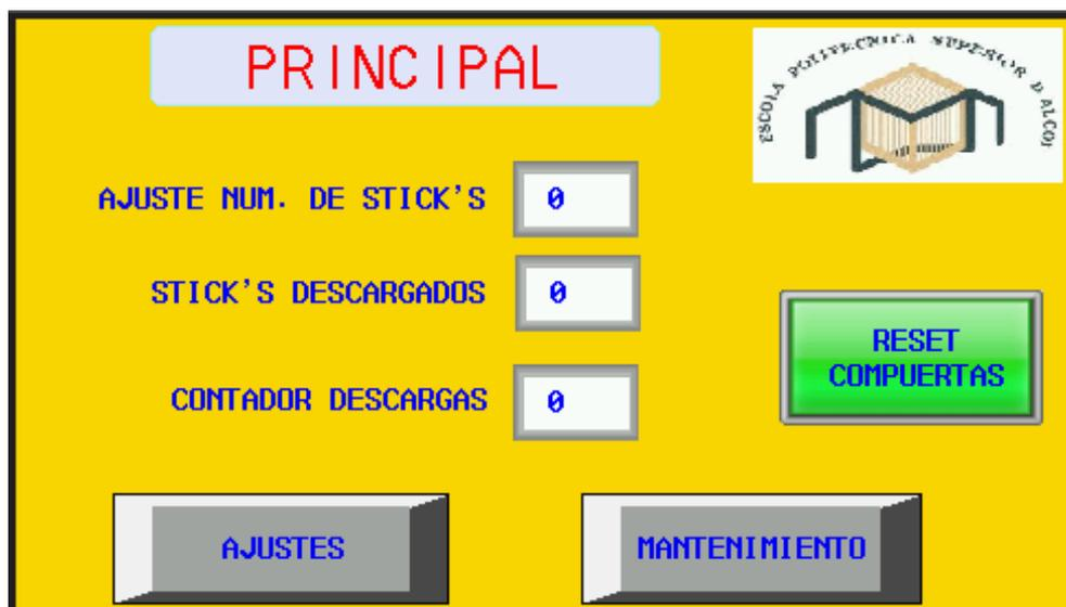
Las compuertas central e inferior se cerrarán, mientras que la superior permanecerá abierta. Una vez contabilizada la cantidad de sticks de golosina fijada en la pantalla de Ajustes como "Sticks en comp. central", la compuerta central realizará el movimiento horizontal de apertura y cierre, dejando caer los sticks de golosina a la compuerta inferior. Este proceso se repetirá sucesivamente, dependiente del ajuste de número de sticks de golosina en la compuerta inferior y total por caja.
