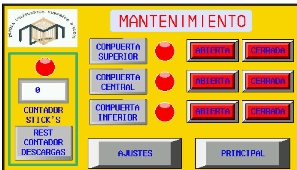
Accionando el pulsador “Compuerta (superior/central/inferior)” se conecta la correspondiente electroválvula, cambiando el piloto de rojo a verde. Con una nueva pulsación, se desconectará la electroválvula correspondiente y volvería al rojo.
