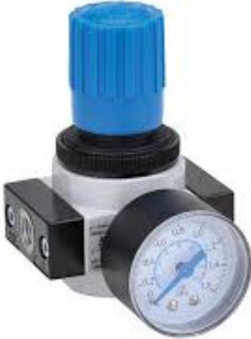
Un Manorreductor o válvula reductora de presión es un dispositivo que permite reducir la presión de un fluido en una red. El más sencillo consiste en un estrangulamiento en el conducto que produce una pérdida de carga o presión (ej. válvula medio cerrada) para reducir la presión pero la presión final variará mucho según la presión de entrada y el caudal. Si aumenta el flujo la presión bajará y si se detiene la presión se igualará con la de alta presión.
