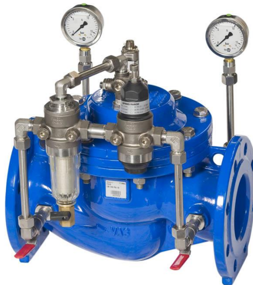
Figura 14 Válvula reguladora de presión con sendos barómetros para medir la presión aguas arriba y aguas abajo
