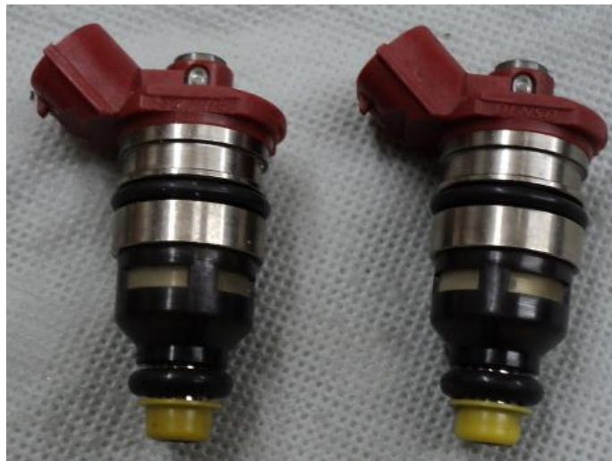
Figura 78. Inyectores "side-feed" originales de 850cc.
