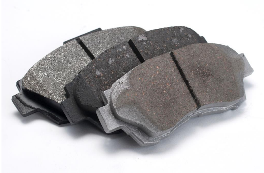
Figura 42. Pastillas de freno con distinto tipo de compuesto.
