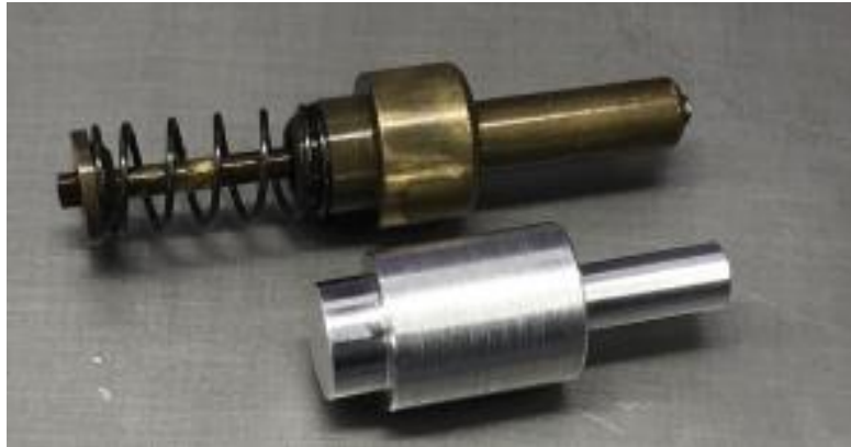
Figura 88. Comparativa entre el termostato del eje excéntrico original y el instalado.
