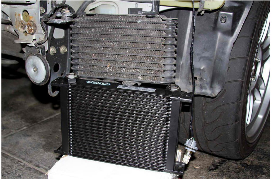
Figura 87. Comparativa entre el radiador de aceite original y el radiador Setrab de 25 filas.
