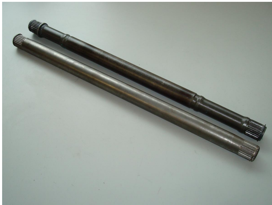
Figura 97. Comparativa entre el palier original (arriba) y el elegido (bajo).
