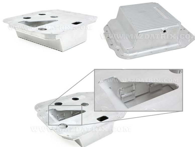
Figura 89. Cárter de aluminio tabicado para evitar el descebado de la bomba de aceite.
