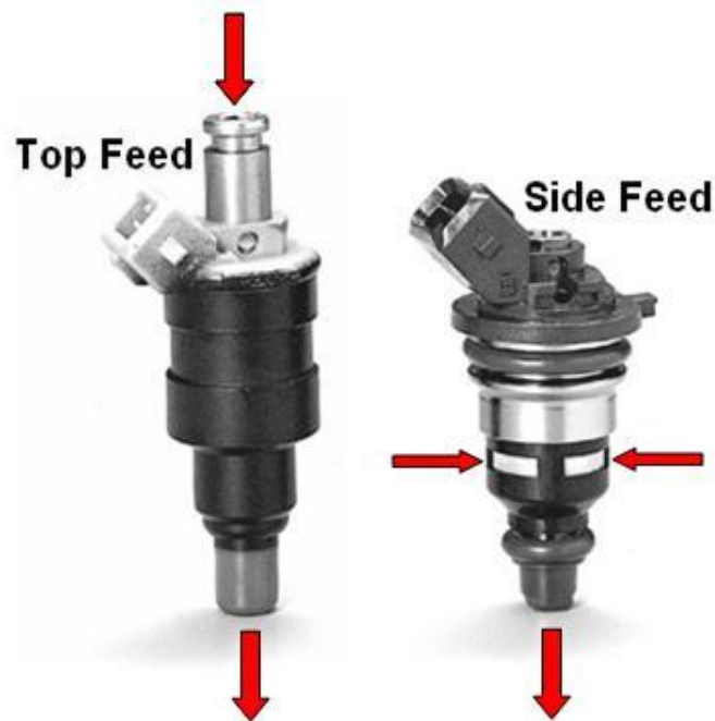
Figura 81. Comparativa entre inyectores "top feed" y "side feed".
