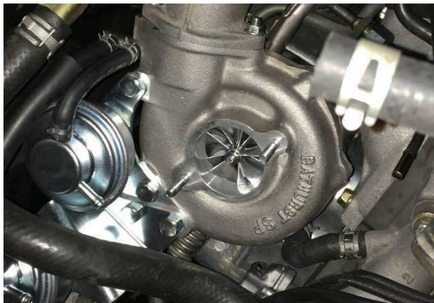
Figura 68. Unidad turbocompresora Hitachi Bathurst SP.
