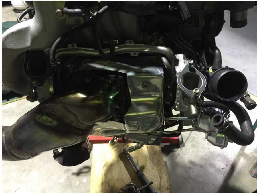
Figura 69. Unidad biturbo Hitachi Bathurst SP y primer tramo del escape.
