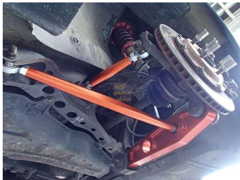
Figura 105. Brazos traseros de suspensión regulables.
