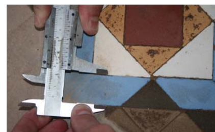
Imágenes 51 y 52. Sistema de toma de datos para el levantamiento métrico de los mosaicos Nolla. (Fuente: Angela López Sabater)
