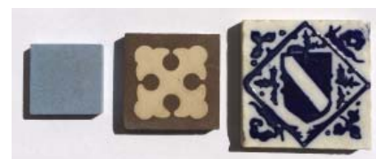
Imagen 53. Los tres tipos principales de cerámica Nolla: monocroma maciza teñida en masa, encáustica con dibujo de un color sobre base de otro color y olambrilla de un color (azul o negro) sobre fondo blanco. Cada tipo corresponde a una técnica de producción propia. (Fuente: Angela López Sabater)
