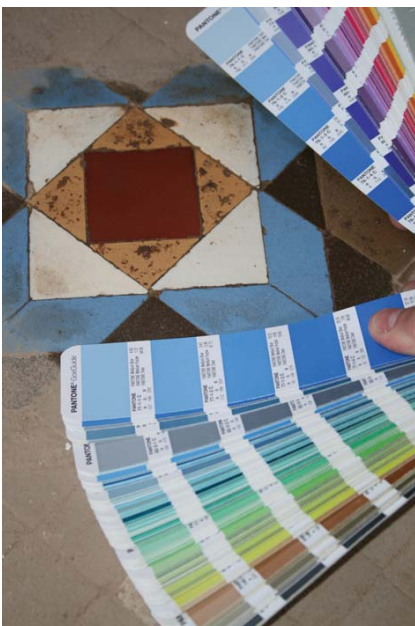
Imágenes 67 a 69. Toma de datos, caracterización de las piezas con carta de color (Fuente: Angela López Sabater)
