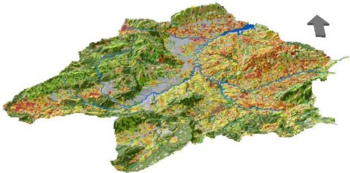
**Figura 58.** Modelo digital del terreno con la representación de los estados erosivos. Fuente: Elaboración propia.
